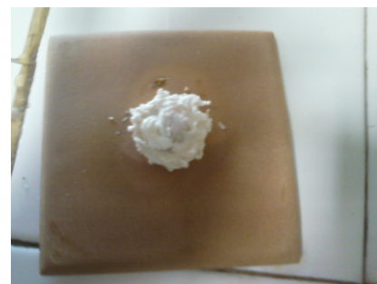
Figura 2.5: Evidente deformazione post sinterizzazione.
